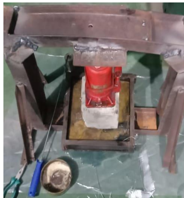
Gambar 4. Proses Penekanan ( Press ) dan Curing pada Pembuatan Komposit Hybrid
