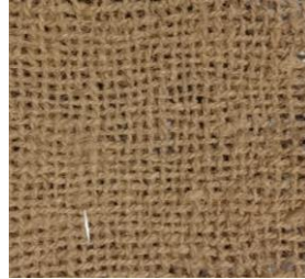
Gambar 3. Anyaman Serabut Kelapa Hasil Penekanan ( hydraulic press )
